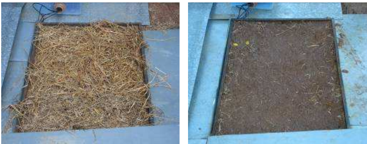
Figura 21 – Detalhe das condições de cobertura, solo coberto (a) e solo descoberto (b).
