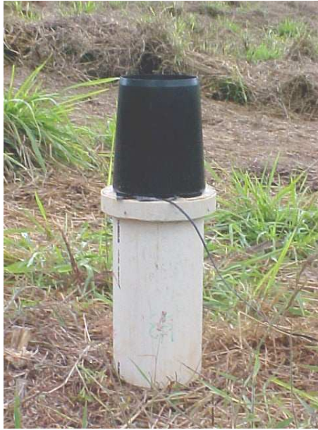
Figura 26 – Pluviógrafo do tipo pulso (a) utilizado na aquisição de dados de precipitação conectado ao “Datalogger” (b).
