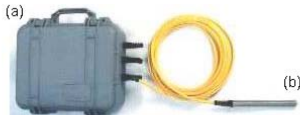
Figura 29 - Foto representativa do “data logger “ (a) e linígrafo (b).
