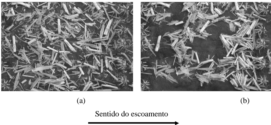
Figura 19. Imagem do momento anterior à aplicação do escoamento superficial para uma quantidade de resíduos soltos de milho equivalente a 1.875 \text{ kg ha}^{-1} , plantio em nível, espaçamento normal entre plantas, declividade da superfície de 4 % (a) e após a aplicação da vazão de escoamento superficial de 1,76 \text{ L s}^{-1} \text{ m}^{-1} (b).
