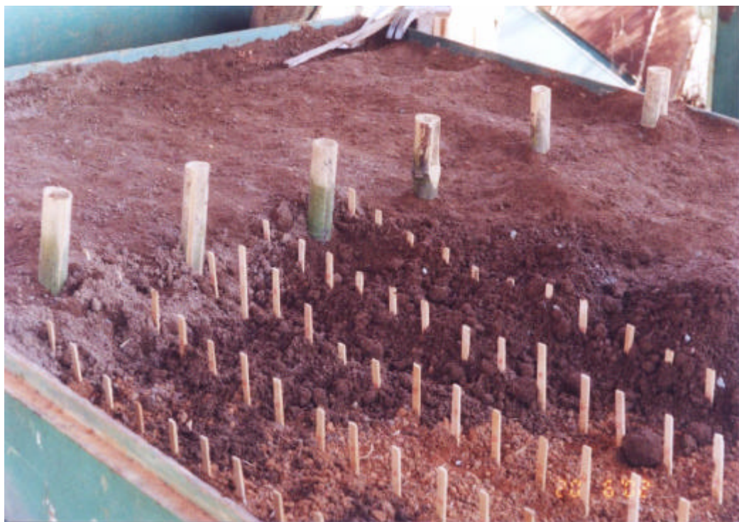
Figura 6. Detalhe da colocação do solo cimento até o topo de cada palito de madeira.
