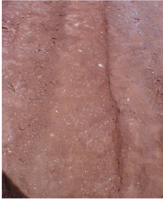
Figura 3. Condição do horizonte C_{(\text{residual maduro})} do solo antes da realização dos testes.
