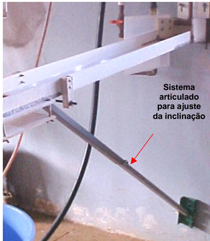
Figura 15. Ilustração do sistema articulado para ajuste da inclinação da rampa.
