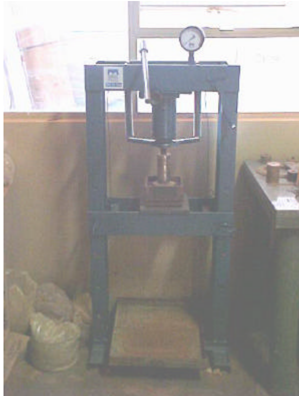
Figura 16. Prensa utilizada para a compactação do solo no amostrador quadrado.
